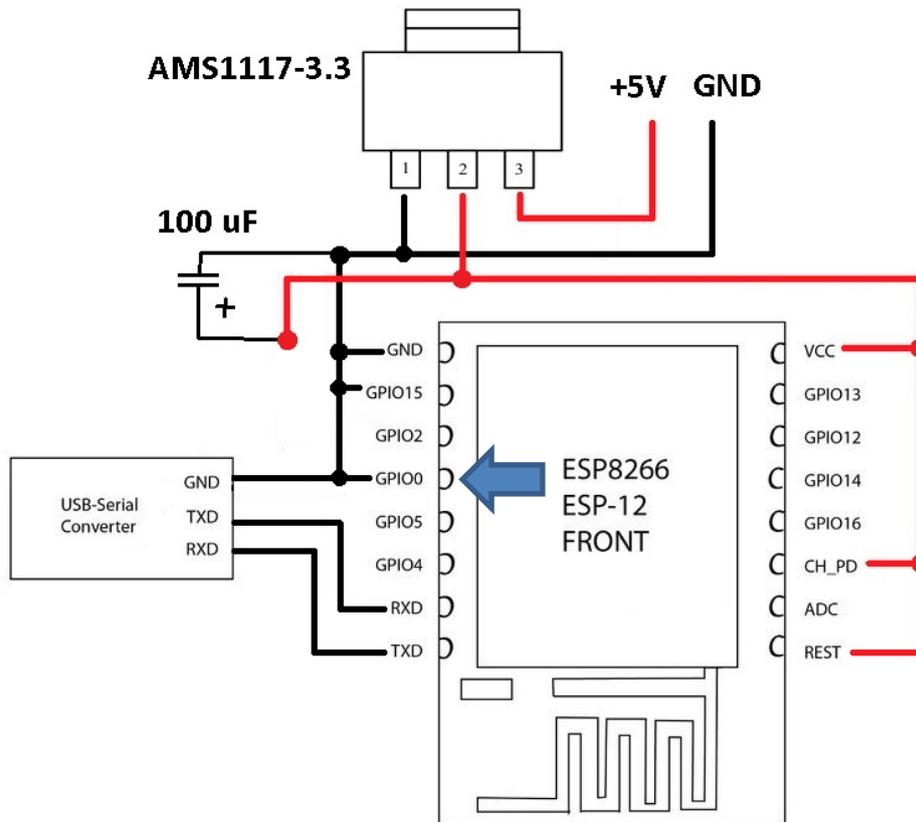
2. Запускаем программу PyFlasher выбираем COM-порт, выбираем прошивку, выбираем Erase Flash – yes, wipes all data и нажимаем кнопку Download. Если прошивка не пошла, проверяем схему еще раз.
